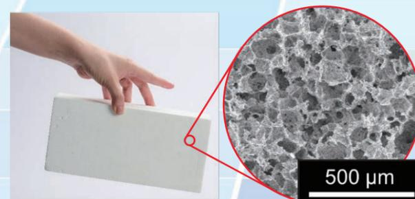
出典:美濃窯業株式会社HP。産業技術総合研究所と美濃窯業が共同開発したファイバーレス高強度高断熱性材料
